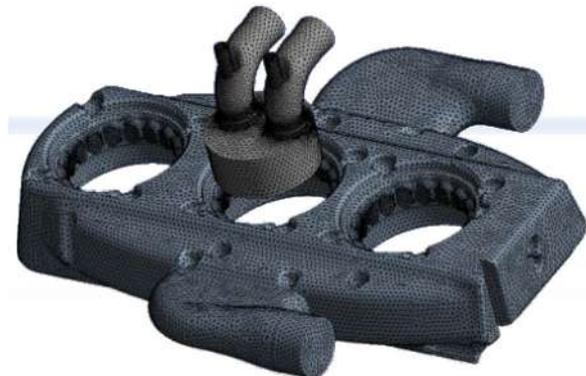
*Figura 1. Rappresentazione mediante CAD e griglia di calcolo del plenum con doppio condotto di aspirazione all'istante iniziale della simulazione.*
