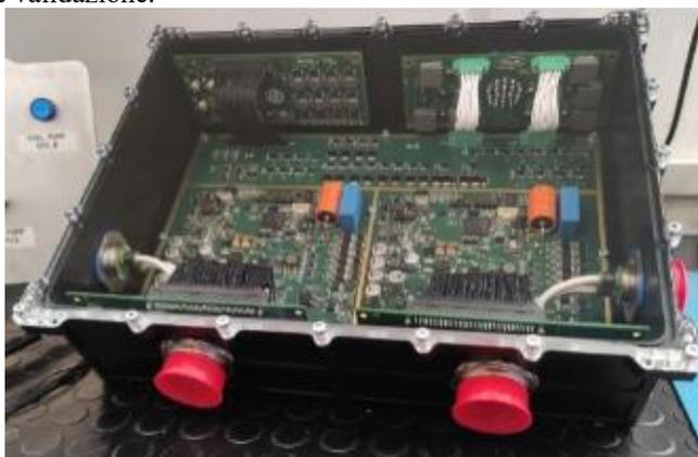
Il sistema di controllo FADEC nella sua versione Model\_0C
