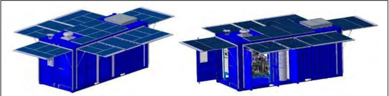
container reingegnerizzato per posizionamento moduli fotovoltaici
