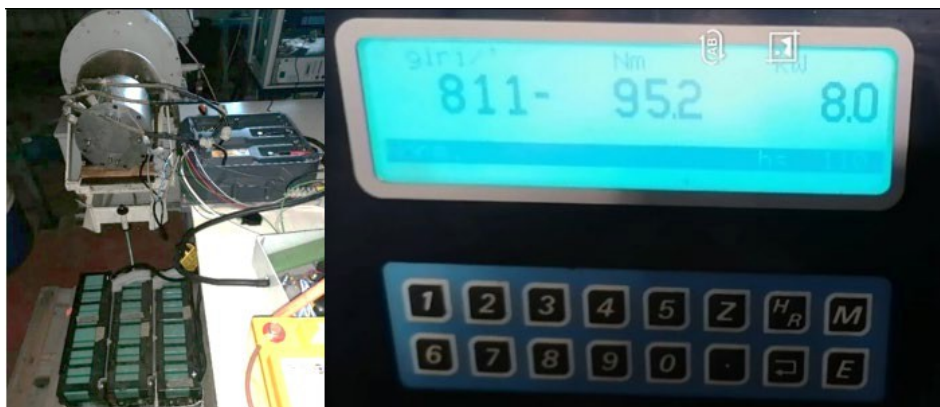
Figura 2: Motore, Inverter e pacco batteria nei test al banco.
