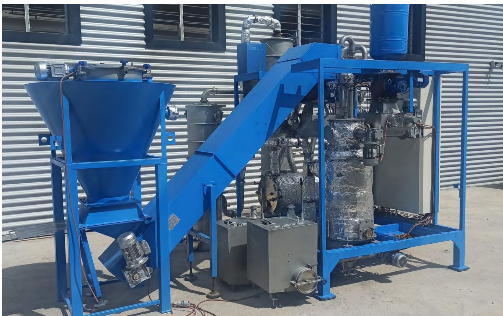
Figura 2 – Progettazione di un innovativo reattore a letto fisso alimentato a fanghi di depurazione
